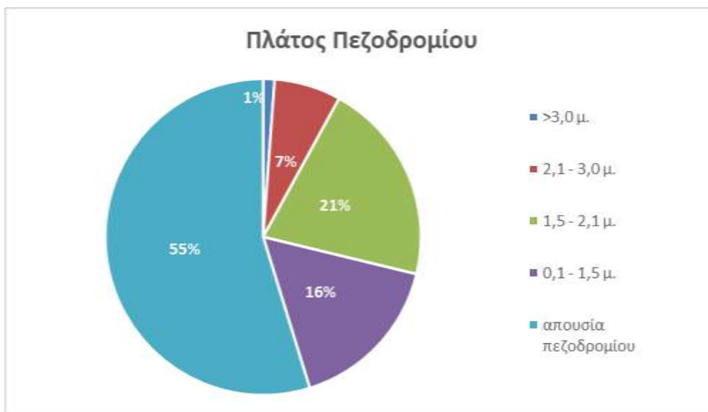
Εικόνα 25: Ποσοστό πλάτους πεζοδρομίων σε σχέση με το μήκος, στο συνολικό οδικό δίκτυο του Δήμου
